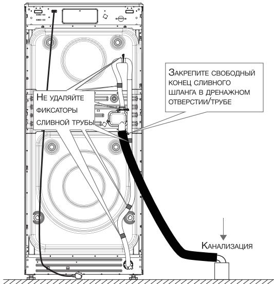
Подключение к канализации возможно одним из двух способов:
